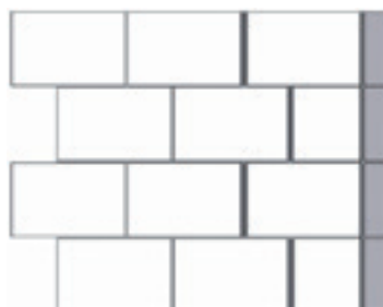
Wanduiteinde met staande voeg
