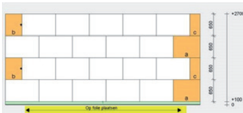
Wanden op doorbuigende ondergronden op folie plaatsen.
