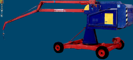
Grue de pose NK375
